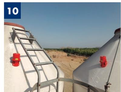
Figuras 7, 8, 9 y 10: Sistema de control de stock de pienso mediante célula de carga y lectura láser.
