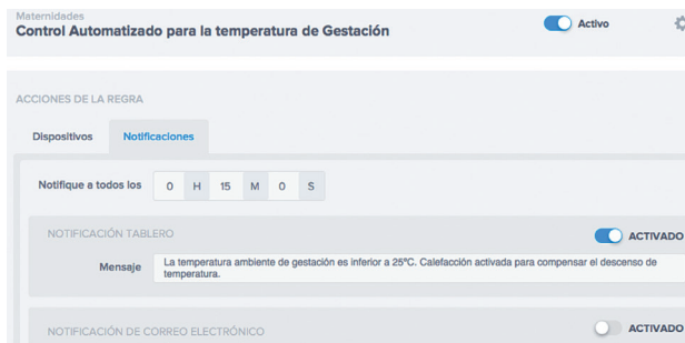
Figura 2. Panel con gestión de alarmas y avisos por temperatura.
