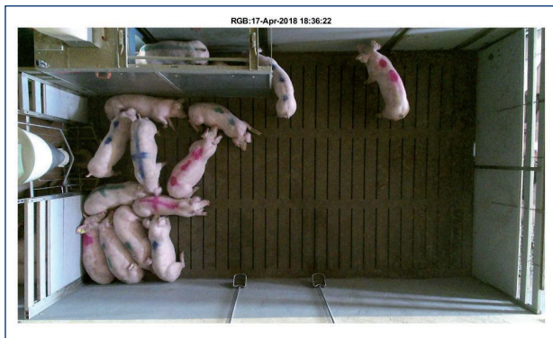
Figura 7. Sistema de análisis de imagen capaz de calcular el peso de cada individuo.
